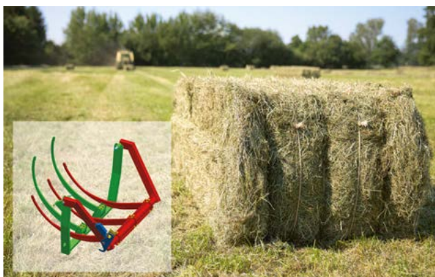
Zwei plus drei Knoten bei der BiG Pack 870 HDP (XC) MultiBale
