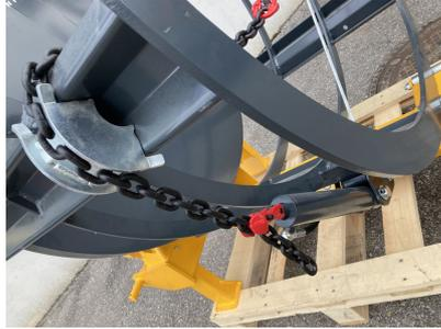
+ Hydraulische Vorspannung
