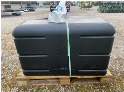
alle mit Dreipunktaufnahme in KAT 2 sowie Zugmaul in schwarzer Lackierung!
