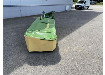
+ Scheibenmäherwerk mit 7 Mähscheiben + Antriebsdrehzahl: 540 1/min + Federentlastung
