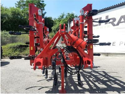
Der Federzinken hält mit einer Auslösekraft von 150 kg und einem Ausfederweg
