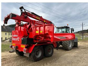
Antrieb über Zapfwelle
