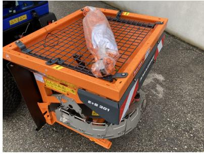
+ Antrieb über Zapfwelle
